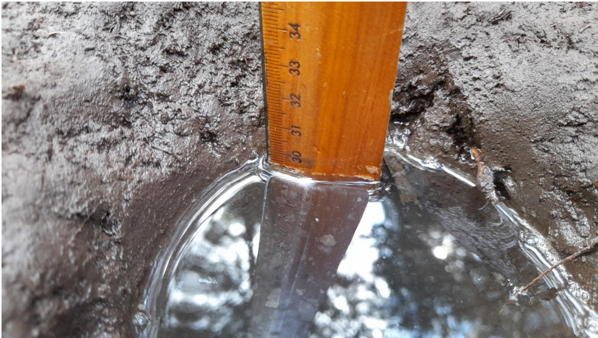
Fotografía 5. Profundidad del agujero (30 cm) e inicio de prueba de infiltración.
