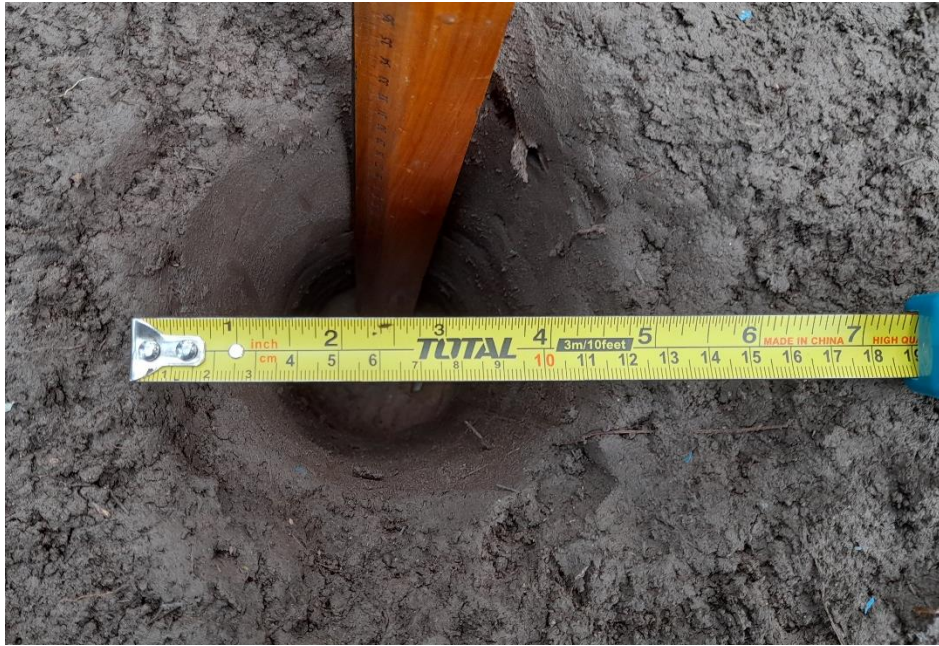
Fotografía 5. Profundidad del agujero (30 cm) e inicio de prueba de infiltración.
