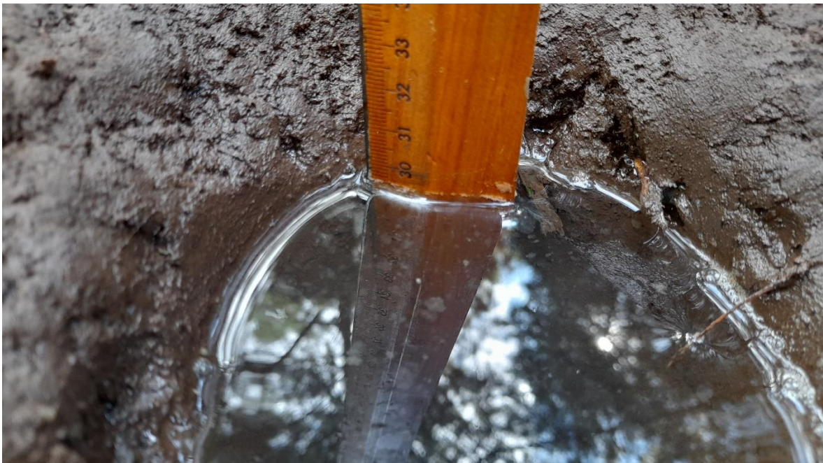
Fotografía 3. Saturación de las paredes del agujero.
